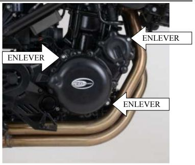
$\frac{\text{Le kit doit contenir}}{\text{1 x Engine Protection carter moteur}}:$  3 x M6x40mm Boulons à tête ronde
