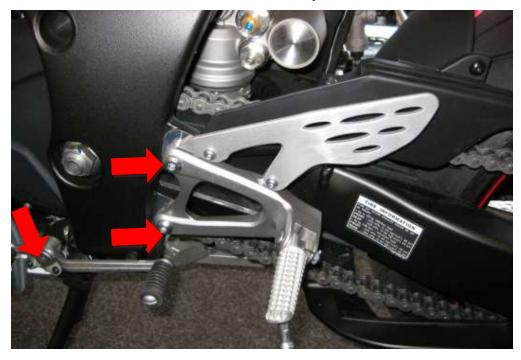
Enlever le train arriered'origineet le levier de vitesses, maisgarderl'arbre de transmission d'origine et le connecteurboite de vitesses.
