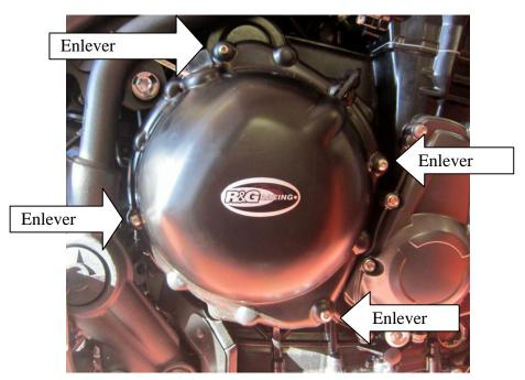
Le kit doit contenir: 1 x Protection carter moteur (ECC0135) 1 x M6x40mm Longs boulons à tête ronde 3 x M6x35mm Longs boulons à tête ronde
