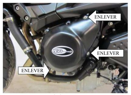
$\frac{\text{Le kit doit contenir:}}{1 \text{ x Protection carter moteur (ECC0143)}} \\ 3 \text{ x M6x40mm Boulons à tête ronde}$
